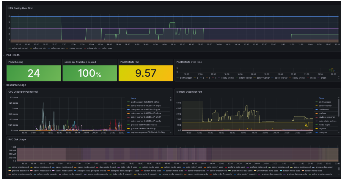
Figura 16: Dashboard Platform Reliability — secções HPA Scaling Over Time, Pod Health e Resource Usage. O gráfico HPA Scaling Over Time mostra o escalonamento da saleor-api de 2 para 4 réplicas durante o load test, com posterior scale-down. A secção Pod Health confirma 25 pods em Running e disponibilidade da API a 100%. Os gráficos de memória e CPU mostram os picos de utilização durante o load test por pod e container.
