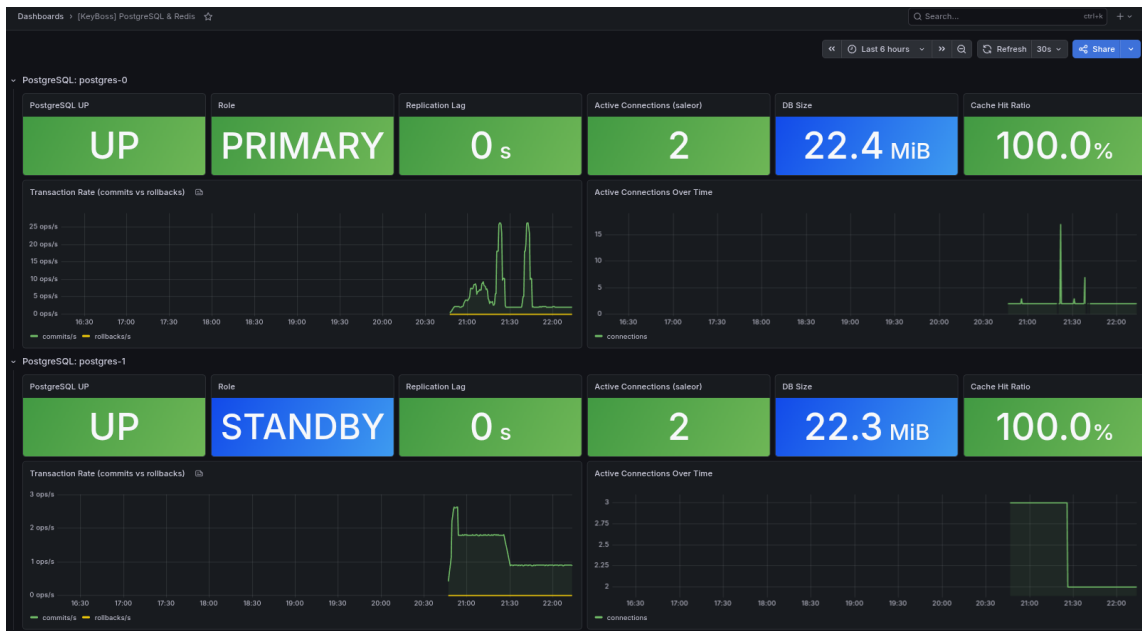
Figura 17: Dashboard PostgreSQL & Redis — seção PostgreSQL: postgres-0 : estado UP, role PRIMARY, replication lag 0s, 2 ligações ativas, base de dados com 21,2MiB, cache hit ratio 100%. Os gráficos temporais mostram a transaction rate (commits/s) com um pico durante o load test e as conexões ativas estáveis.
