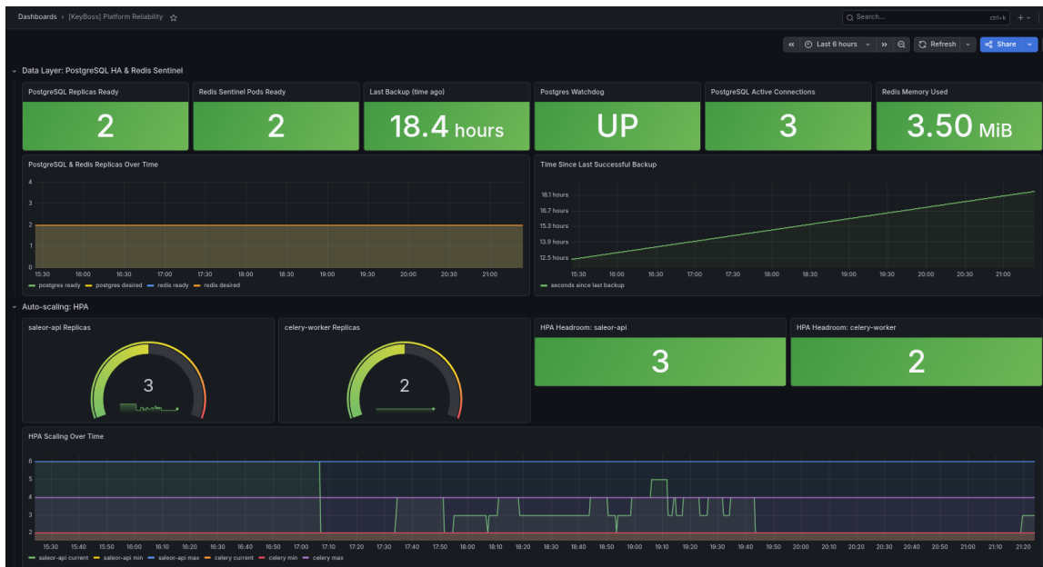
Figura 4: Dashboard Platform Reliability durante o load test: saleur-api com 3 réplicas (HPA headroom = 3), PostgreSQL e Redis estáveis, variação de réplicas visível no gráfico HPA Scaling Over Time .
